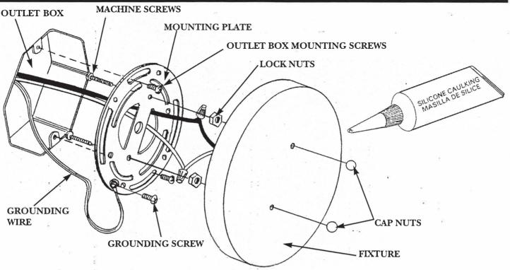
TURN OFF POWER AT THE MAIN FUSE OR CIRCUIT BREAKER BOX BEFORE STARTING INSTALLATION
