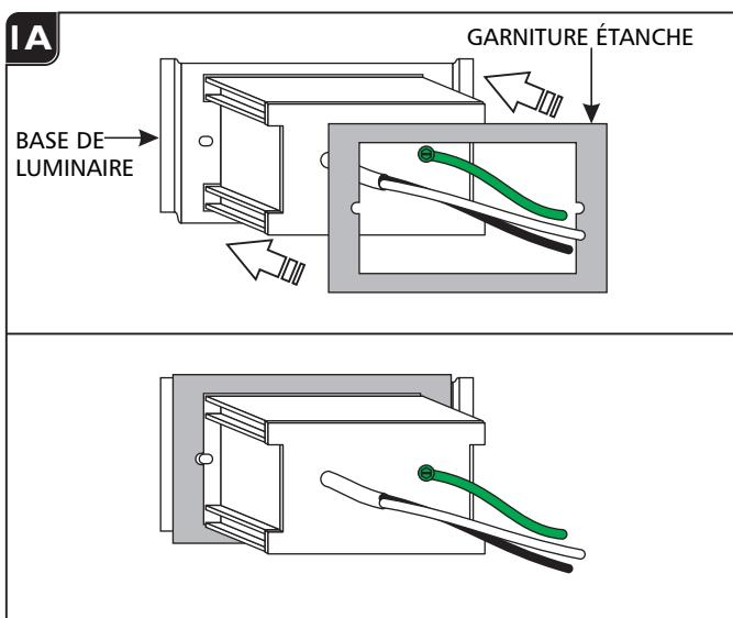
**1A** Requis pour l'installation dans les endroits humides seulement, installer le garniture étanche sur l'arrière de la base du luminaire.
