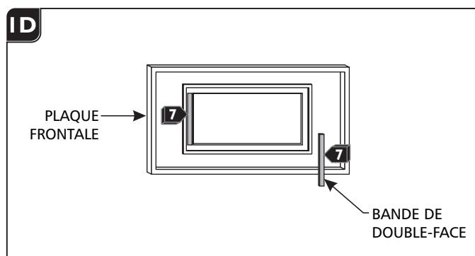
**7** Installez le bande de double-face sur le dos de le plaque frontale comme indiqué. REMARQUE: Appuyez fermement sur le bande de double-face pour se assurer qu'il est correctement collé sur la plaque frontale.
