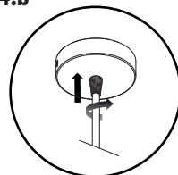
FIX THE WIRE BY CABLE PRESS FIJAR EL CABLE MEDIANTE PRENSA CABLES
